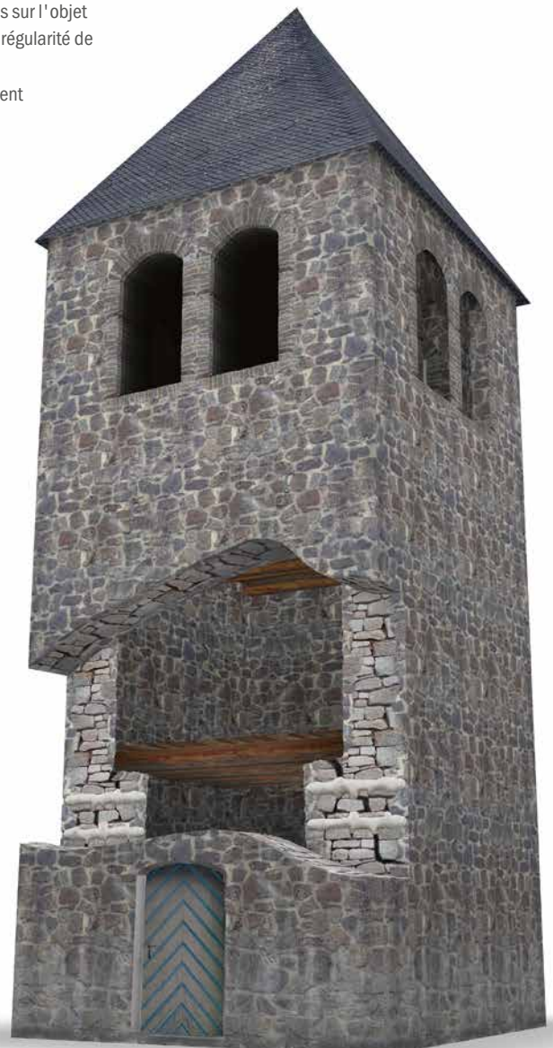
Verbindung abgelöster Mauerwerkschalen Raccordement des murs séparés
